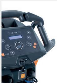
TASKI IntelliKey garantisce sicurezza ed efficienza. Gli utenti autorizzati possono effettuare il login e accedere immediatamente ai programmi che li riguardano. Inoltre la nuova digital Key aggiunge maggiore sicurezza, con lo scollegamento automatico della batteria mentre si ricarica ad esempio.
