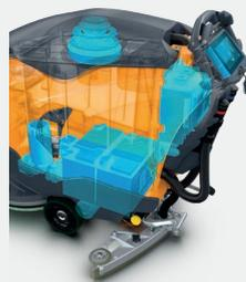
Il sistema IntelliDose+ calcola ed eroga la giusta quantità di prodotto chimico a seconda dell'attività e del pavimento, garantendo risultati perfetti, controllo e riduzione dei chimici utilizzati. Il nuovo design consente di utilizzare sia super-concentrati che prodotti chimici standard. IntelliDose+ garantisce sicurezza del personale, eco-sostenibilità, controllo dei costi, semplificazione delle operazioni di lavoro.
